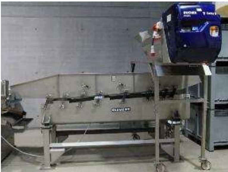
Abb. 2: Vorselektionseinheit für den VOT
