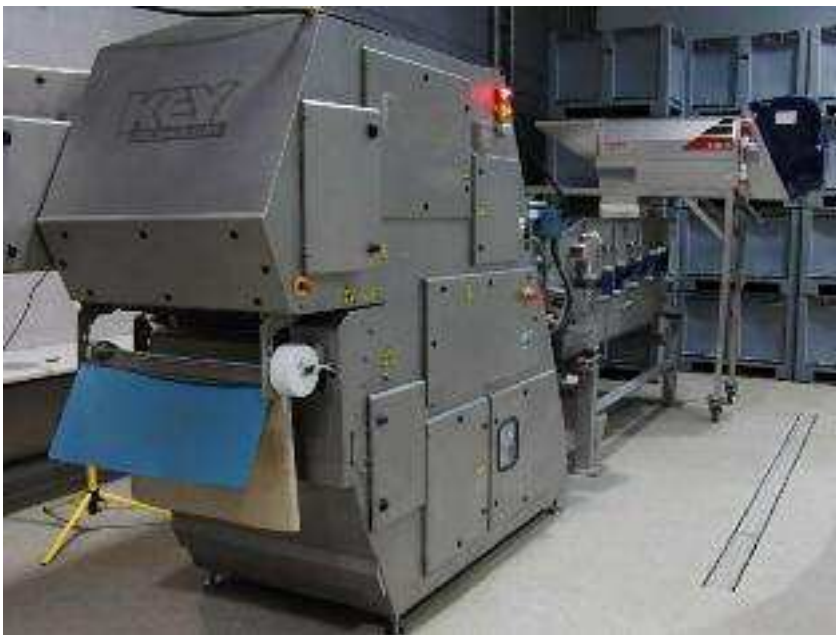
Abb. 1: Vollautomatische optische Traubensortierung (VOT)
